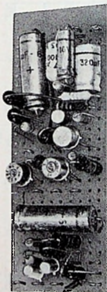
Afb. 10 Stuurtrap voor sindtransistoren en stabilisator op een half plaatje Montaprint.
